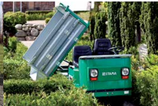
STAMA Multi Truck 48v 1 meter bred arbejdshest, der kan komme frem på selv de smalleste stier. Stort udstyrsprogram og kan leveres indregistreret og med lithium batterier
